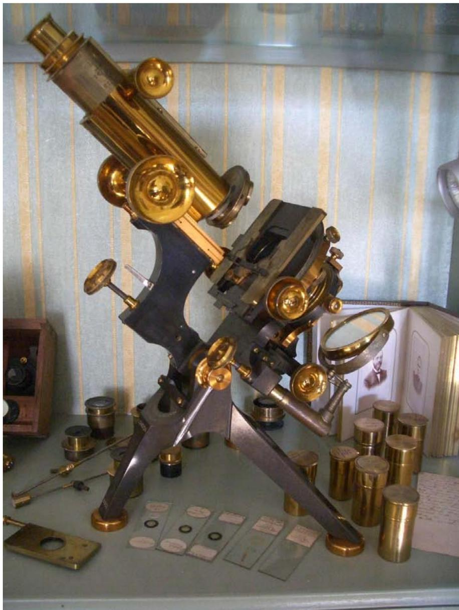
*Figure 101 : Microscope “Grand Model van Heurck” construit par la maison W. Watson & Sons à Londres à partir de 1897, le plus prestigieux, le plus perfectionné de ses microscopes, que d’ailleurs le constructeur continua à produire (sur commande uniquement) jusque dans les années 1940 (collection de l’auteur)*
