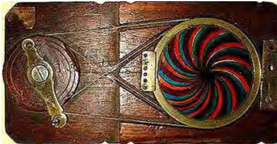
Figure 40 : Chromatope datant de +/- 1872. l'on aperçoit l'un des deux disques de verre coloré et les courroies dont on comprend, par leur montage, qu'ils feront tourner les deux disques superposés en sens inverse, en actionnant la manivelle.
